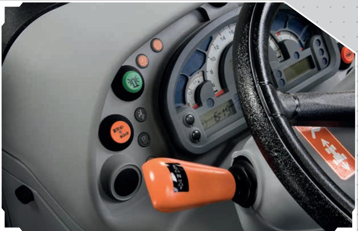
die Gänge ganz einfach und ohne Betätigung des Kupplungspedals wechseln. Dank der umfangreichen Kombinationsmöglichkeiten von Reifengröße und Getriebe können die Modelle der neuen Explorer TB-Familie bis zu einer Geschwindigkeit von 40 km/h mit weniger als 2000 U/min gefahren werden. Dies führt auch bei schnellen Straßenfahrten zwischen den Einsatzorten zu einem geringeren Kraftstoffverbrauch.
