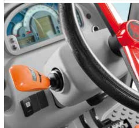
In die rechte Konsole integrierte Bedienelemente.
