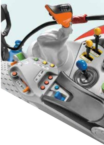
Armlehne und Getriebe für die „Basic“-Ausführungen mit manueller Schaltung.
