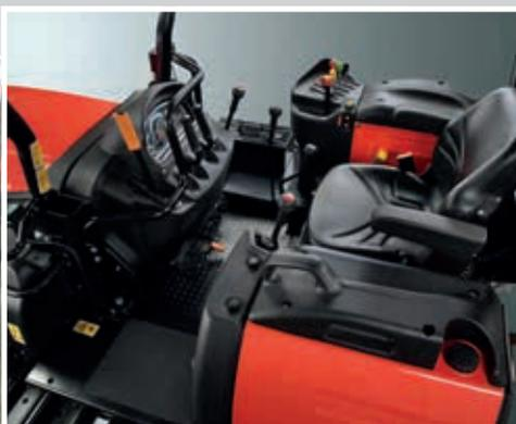
Puesto de conducción con suelo plano y nueva disposición de las palancas de dirección.
