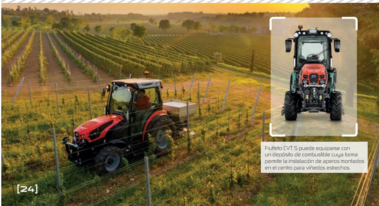
Frutteto CVT S puede equiparse con un depósito de combustible cuya forma permite la instalación de aperos montados en el centro para viñedos estrechos.
