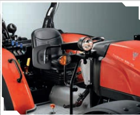
Espejos retrovisores instalados en la parte delantera de la plataforma, opcionales.
