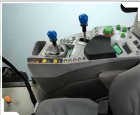
Palanca mecánica en cruz para accionar 4 vías hidráulicas con el mismo mando.
