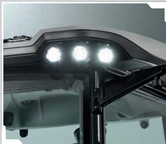
Techo con nuevo diseño con hasta 12 faros de trabajo LED.
