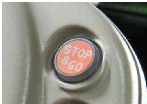
La función Stop&Go permite gestionar el movimiento del tractor con solo accionar el freno y sin necesidad de recurrir al embrague. Una solución muy útil cuando se trabaja con la pala cargadora, en la fase de enganche de los aperos o para reemprender la marcha en cuestas.
