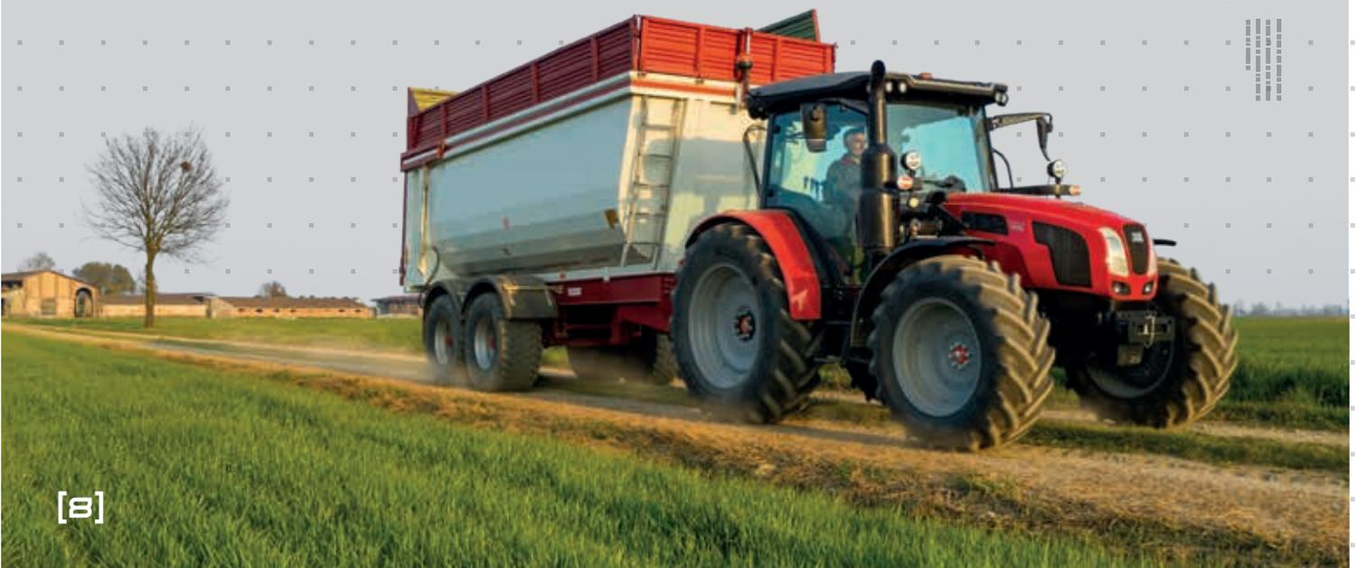
EXPLR ES UN MARCHA ATRÁS MECÁNICA O UN INVERSOR HIDRÁULICO REGULABLE QUE INCLUYE LA FUNCIÓN STOP&GO, Y CAMBIO BAJO CARGA DE 2 O 3 MARCHAS, AMBOS ALCANZAN UNA VELOCIDAD DE 40 KM/H CON EL MOTOR EN RÉGIMEN ECONÓMICO.
