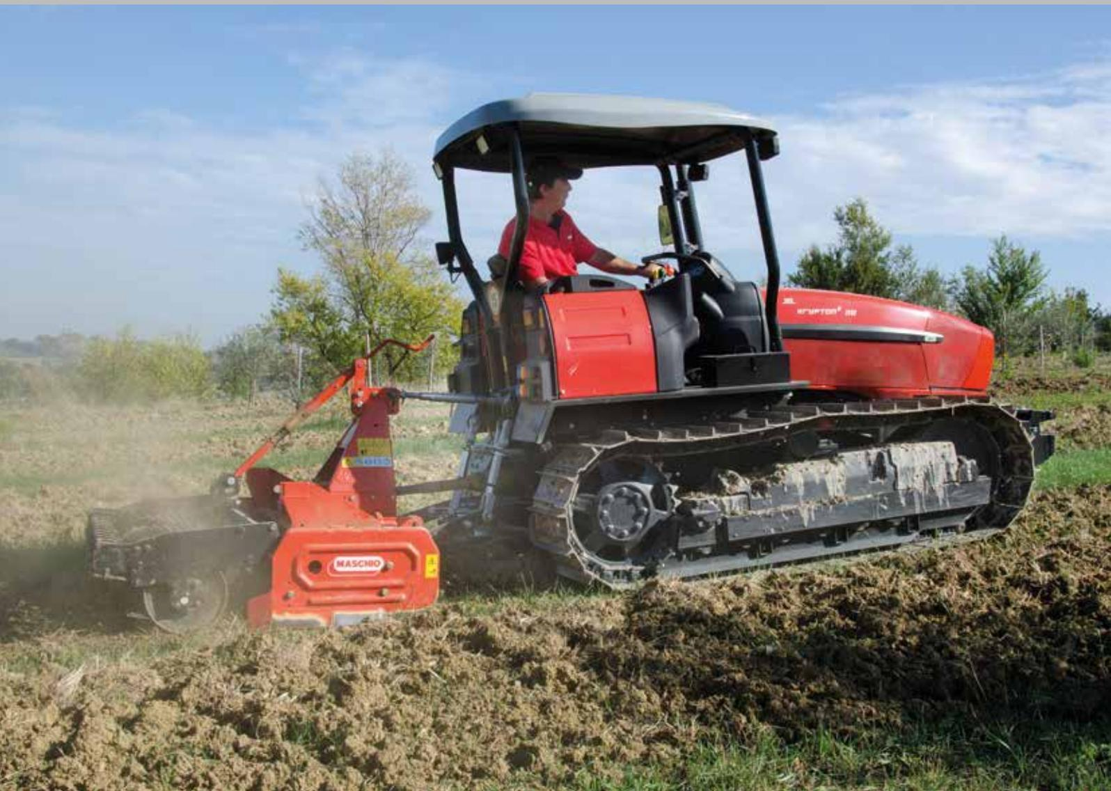
El elevador trasero es de tipo mecánico con control de posición, esfuerzo, mixto y flotante, tiene una capacidad de elevación de 3.000 kg para todas las versiones y satisface ampliamente las necesidades de su gama. Para los Krypton<sup>3</sup> V, existe también una versión reforzada, adecuada para aperos pesados o que requieren esfuerzos de tracción elevados. La regulación del es-
