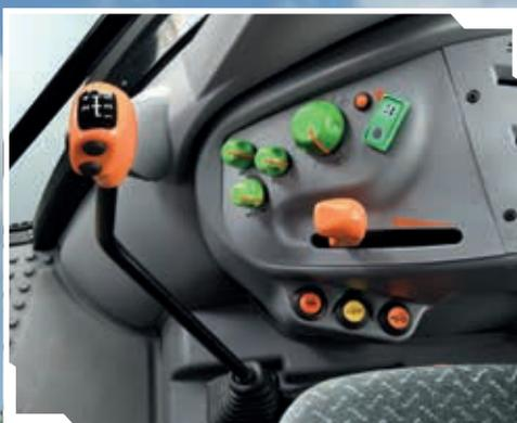
Relevage arrière électronique avec amortissement des vibrations.
