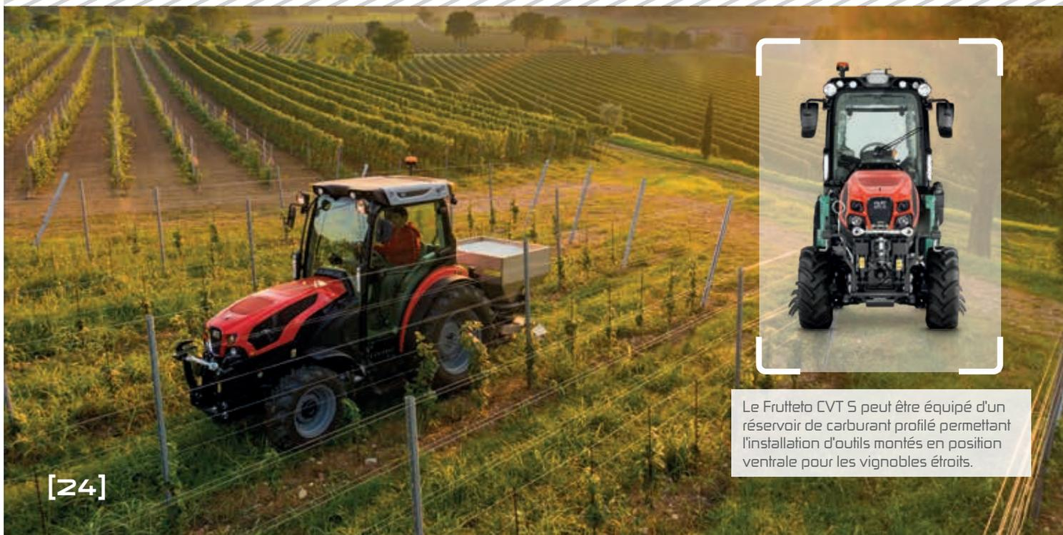
Le Frutteto CVT S peut être équipé d'un réservoir de carburant profilé permettant l'installation d'outils montés en position ventrale pour les vignobles étroits.
