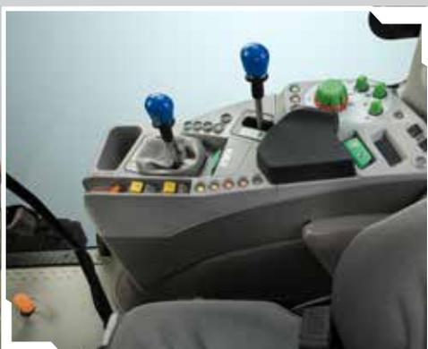
Levier mécanique en croix pour activer 4 voies hydrauliques avec la même commande.
