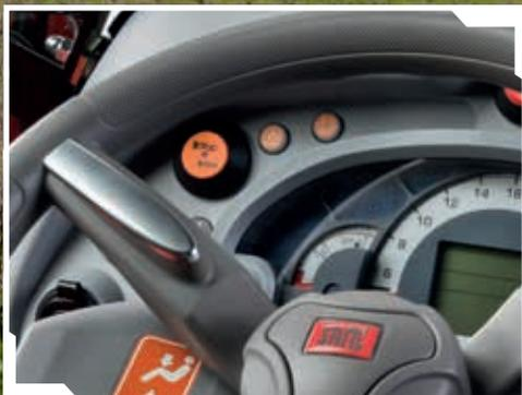
Stop&Go de série sur tous les tracteurs équipés de l'inverseur électrohydraulique PowerShuttle.
