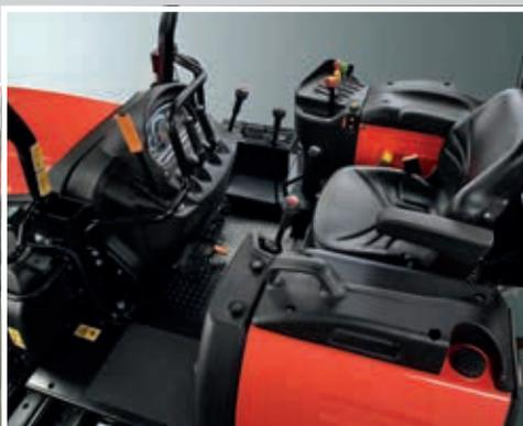
Poste de conduite avec plancher plat et nouvelle disposition des leviers de direction.
