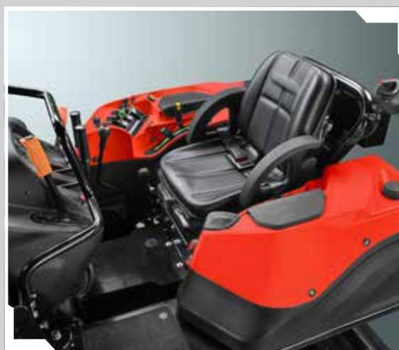
Poste de conduite confortable monté sur Silent-Blocks.
