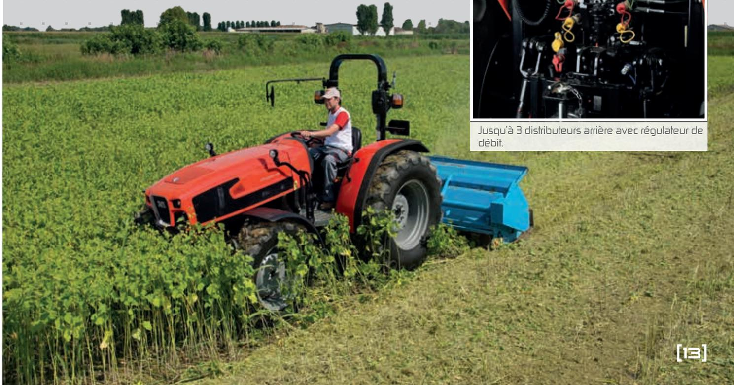
Jusqu'à 3 distributeurs arrière avec régulateur de débit.
