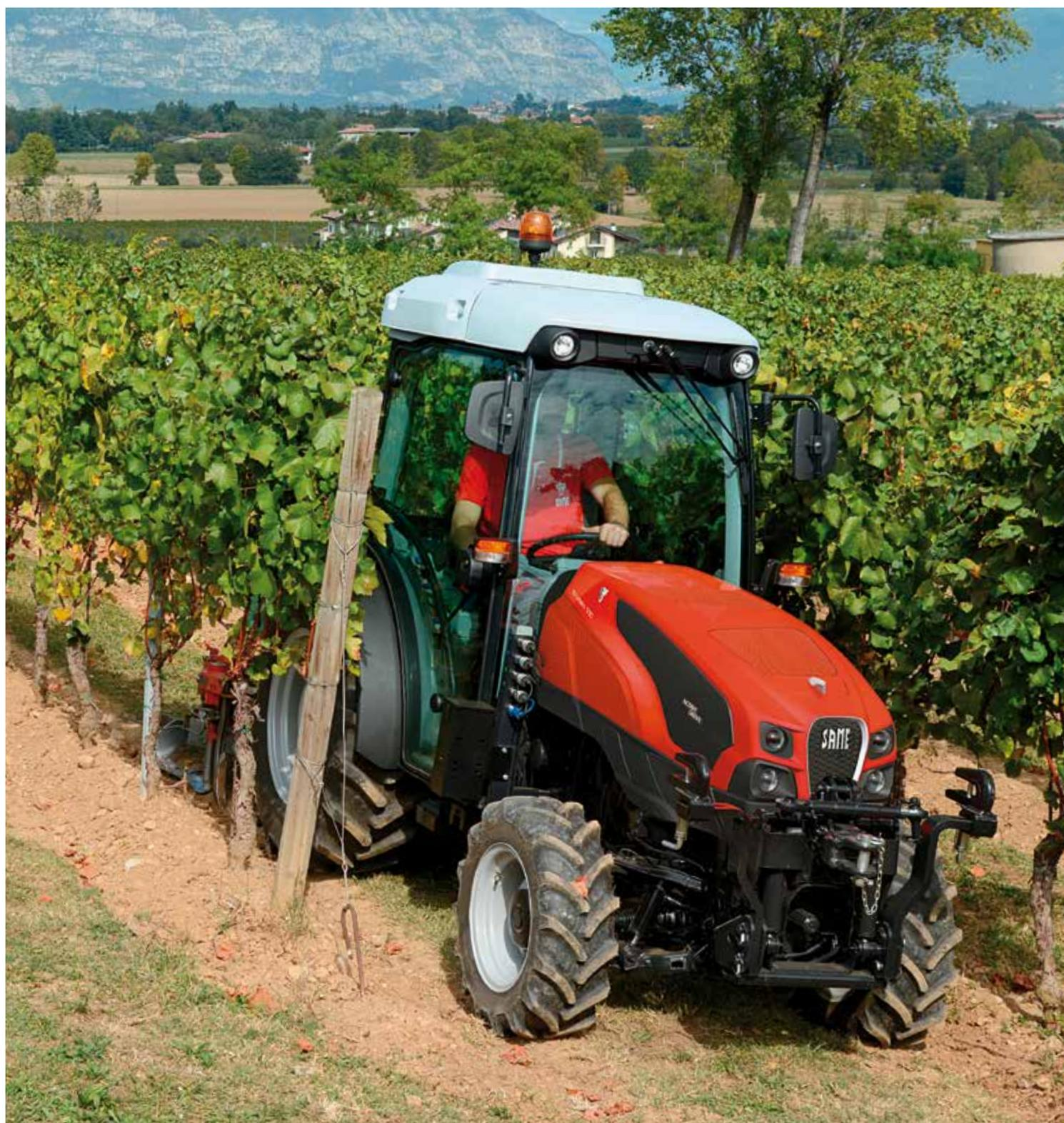
**S**ur les 4 roues, pour une plus grande sécurité dans les transports. Sur les 2 roues latérales (à droite ou à gauche, avec un arrêt mécanique qui unit les deux pédales de frein correspondantes), pour augmenter le rayon de braquage dans les manœuvres très serrées. Ou bien sur une roue (arrière droite ou gauche, en agissant sur la soupape « Separate Brake », pour exclure les freins avant), pour éviter d'endommager la couche arable par le blocage des roues avant en phase de braquage.
