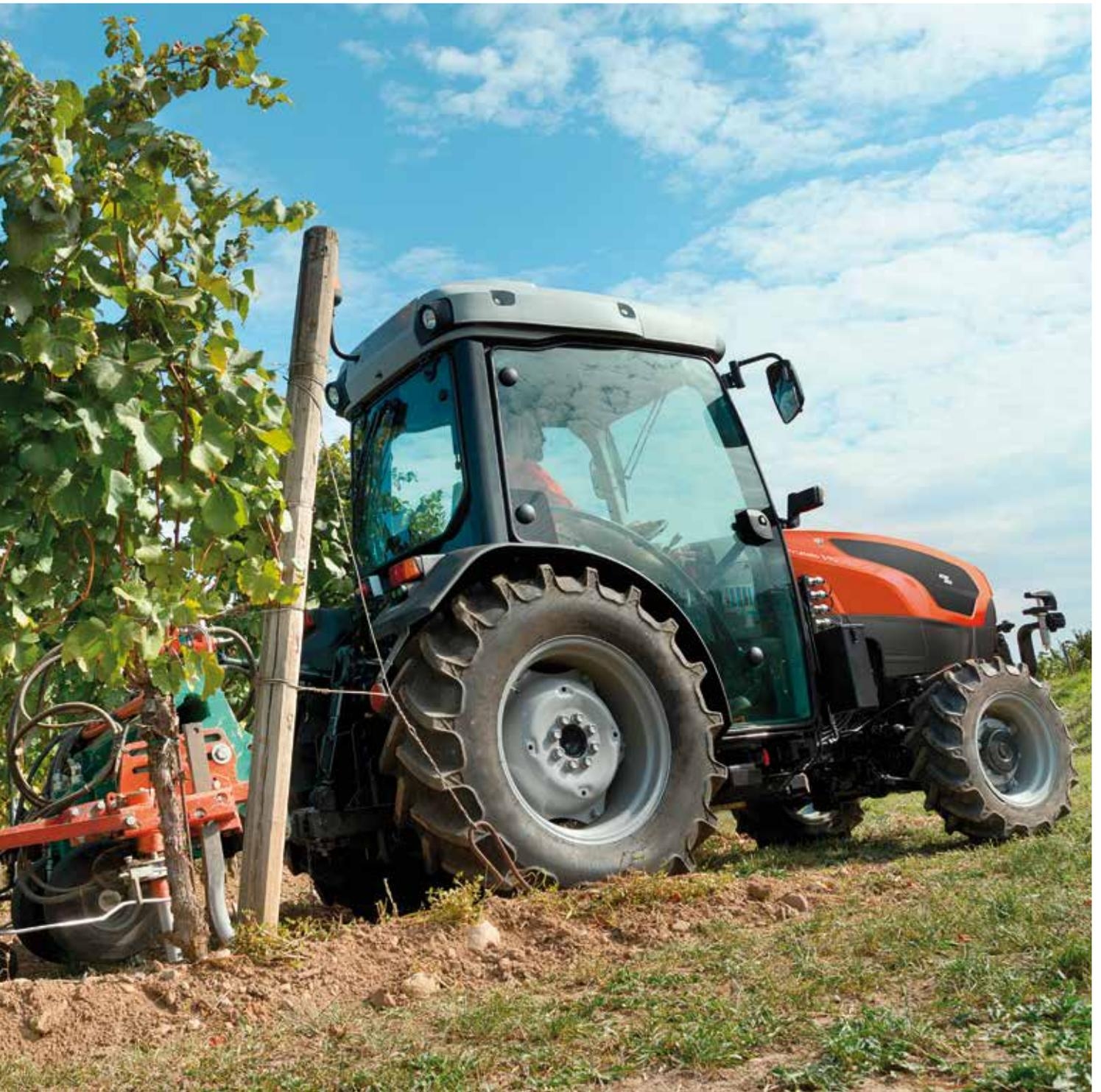
diesel dans les travaux avec les machines à ébourgeonner et les bineuses entre les rangs. La PDF proportionnelle, généralement utilisée avec des remorques à essieu moteur, est également disponible pour le transport sur les pentes raides. Extrêmement simple, même dans la gestion : le bouton d'engagement de l'embrayage (à commande électrohydraulique) est à activation
