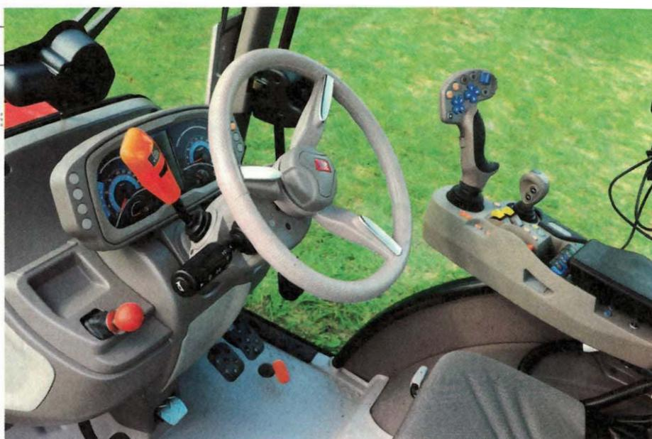
dispositif de blocs en caoutchouc dans lesquels circule un fluide qui réduit les vibrations. « Avec le pont-avant suspendu Active Drive, on ne sent quasiment plus de vibrations, en particulier sur la route », promet Nicolas Bedrune. En plus de l'accoudoir multifonctionnel équipé d'un joystick orientable, un second joystick paramétrable est installé à droite du chauffeur, en arrière du premier. Il permet au conducteur de commander facilement
