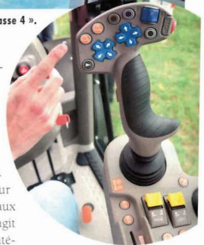
L'accoudeur Maxcom, intégré au siège, permet de configurer de nombreuses fonctions.
