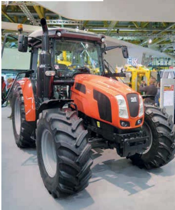
35 ans séparent la première génération exposée au dernier Sommet de l'Élevage, de la dernière version du Same Explorer, présentée lors du salon EIMA 2016. Celle-ci dispose d'un moteur à la norme Tier 4 final FARMotion, avec recyclage partiel des gaz (EGR), associé à leur post-traitement via le système SCR. Ces tracteurs se déclinent en 7 modèles de 3 et 4 cylindres, dans des puissances de 80 à 119 ch.
