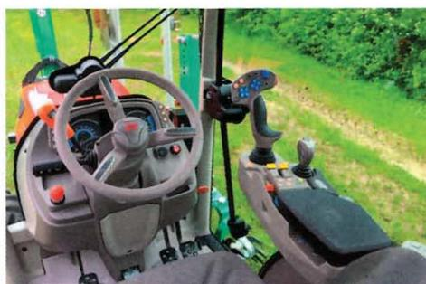
renouvellement d'air de 30 m<sup>3</sup>/h. Pour le confort du chauffeur, la structure repose sur des hydrosilentbloks à bain d'huile. L'agencement, digne des tracteurs de forte puissance, regroupe la plupart des commandes à la droite du chauffeur, sur l'accoudoir. Le joystick multifonction, hérité des moissonneuses-batteuses du groupe SDF, prend place à son extrémité. Un second levier en croix, à droite, contrôle trois
