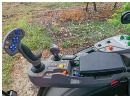
**LE FRUTTETO 105 S EST ÉQUIPÉ D'UN TERMINAL COULEUR TACTILE IMONITOR DE 8 POUCES.** Celui-ci est monté sur un support à double articulation, qui permet de le positionner aussi bien au-dessus du tableau de bord que latéralement dans l'axe du montant avant droit. Personnalisable à souhait, ce terminal propose encore une autre entrée pour régler différents paramètres,
