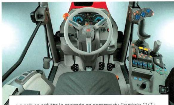
La cabine reflète la montée en gamme du Frutteto CVT : les informations sont affichées sur le tableau de bord réglable, tandis que l'accoudoir permet de commander la transmission et toutes les fonctions hydrauliques.
