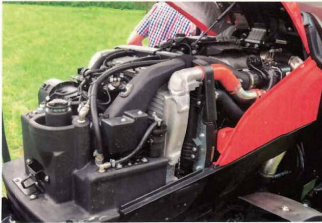
Le Frutteto est équipé d'un moteur FARMotion de 3 cylindres de 2,9 l ou 4 cylindres de 3,8 l.
