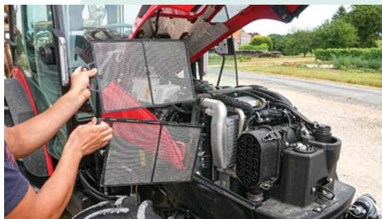
**LA PRÉGRILLE DEVANT LES RADIATEURS EST COMPOSÉE DE DEUX ÉLÉMENTS**, un supérieur qui coulisse et un inférieur qui s'extrait après avoir ôté le premier : inutile donc de démonter un panneau latéral pour nettoyer les grilles. Les filtres à huile et à carburant nécessitent de démonter le panneau latéral droit avec une clé. La jauge à huile est très compliquée à remettre : on procède à tâtons. Le coupe-batterie est très accessible mais
