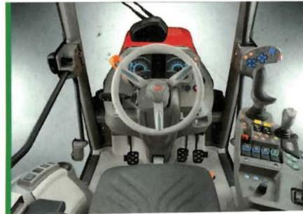
En plus, les commodes leviers "Fingertip" disposés en ligne permettent d'actionner les distributeurs supplémentaires et les relevages avant et arrière. Toutes les commandes ont été conçues pour fournir le plus haut
