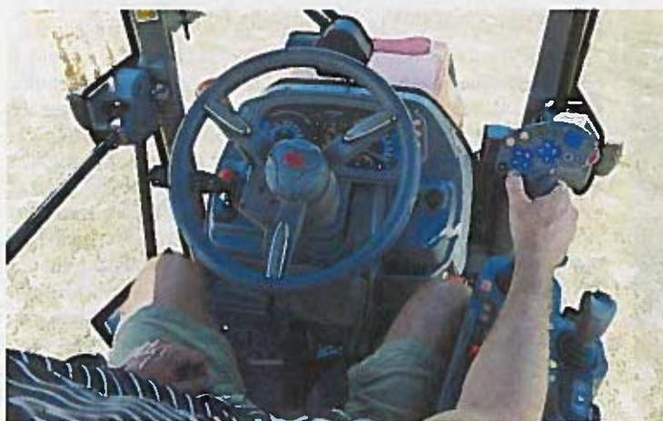
**Accoudoir** Les commandes sont regroupées à droite sur l'accoudoir MaxCom, solidaire du siège. L'accès aux paramètres électroniques et au tableau de bord se fait grâce à une molette intégrée à l'accoudoir.
