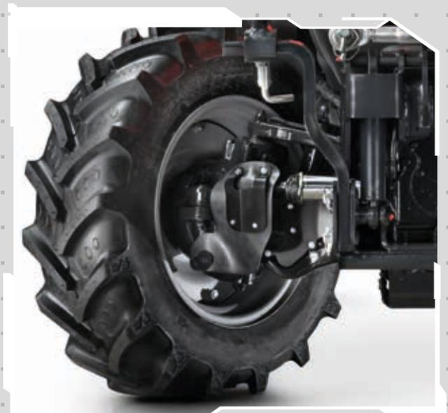
machine conserve une configuration optimale dans toutes les situations, le système contrôle en permanence la capacité d'amortissement. Le logiciel de commande offre également deux fonctions supplémentaires afin d'améliorer la sécurité active de la machine : anti-plongée et anti-roulis.
