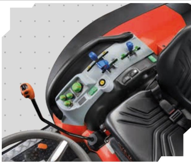
Le relevage arrière à commande mécanique est disponible sur tous les modèles. Le relevage arrière à commande électronique est disponible en option. Le relevage avant est disponible en option. Le système d'amortissement des oscillations est disponible en option.
