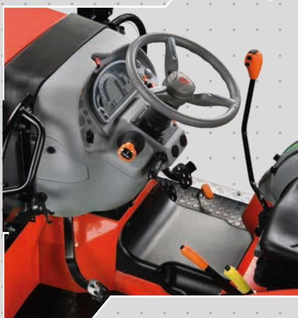
Le poste de conduite est équipé d'un volant réglable en hauteur, qui permet de s'adapter parfaitement aux conducteurs de toute taille, tandis que les commandes ergonomiques organisées selon le code couleur éprouvé de la marque SAME rendent l'utilisation du tracteur extraordinairement simple et intuitive.
