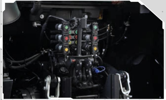
de 55 l/min. Pour compléter l'offre hydraulique, il existe 3 distributeurs arrière disponibles avec des commandes mécaniques, des régulateurs de débit, des collecteurs d'huile hydraulique et un "retour libre". L'Explorer Natural est équipé de série d'un relevage arrière à commande mécanique. Le relevage
