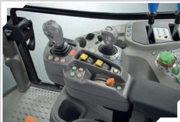
La transmission RVshift équipant les modèles Virtus dispose également de 2 gammes (Normale et Heavy Duty) pour optimiser la force de traction en fonction de la tâche. À toutes les vitesses, de la 1<sup>e</sup> à la 15<sup>e</sup>, la transmission passe automatiquement d'une gamme à l'autre en fonction de la charge du tracteur. La gamme Heavy Duty peut également être sélectionnée manuellement à partir d'un bouton spécifique situé sur le tableau de bord droit de la cabine.
