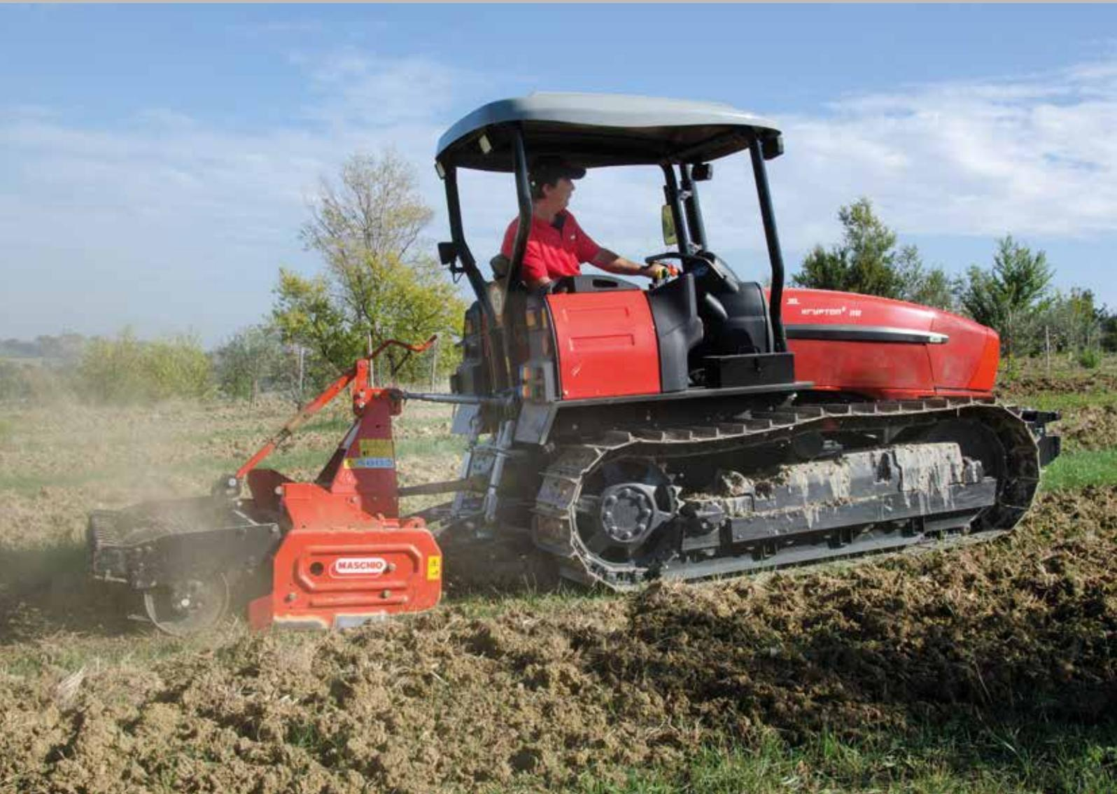
Le relevage arrière est mécanique avec contrôle d'effort, de position, mixte et flottant et assure une capacité de relevage de 3000 kg sur toutes les versions, prêt ainsi à répondre à toutes les exigences de la catégorie. Sur le Krypton<sup>3</sup> V, il est également disponible en version « Heavy duty » pour les outils lourds nécessitant des efforts de traction élevés. Digne de la classe supé-
