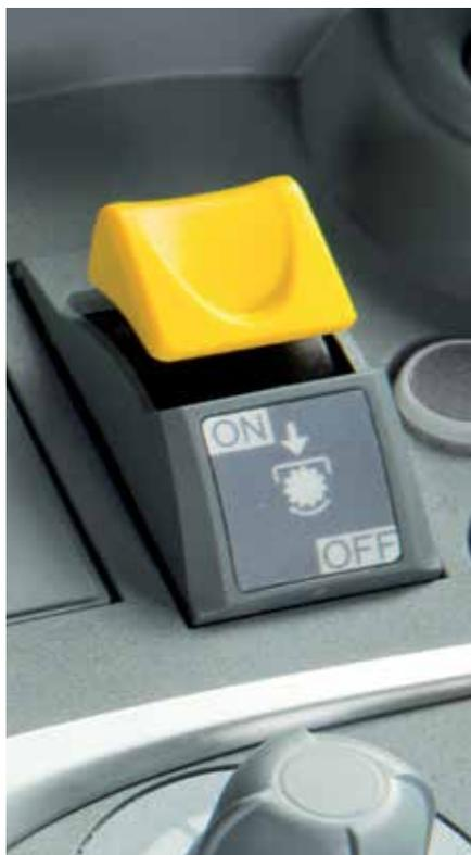
Gli Audax sono equipaggiati con una PTO posteriore a 2 velocità (540ECO e 1000), dotata di frizione a dischi multipli in bagno d'olio a comando elettroidraulico modulato.
