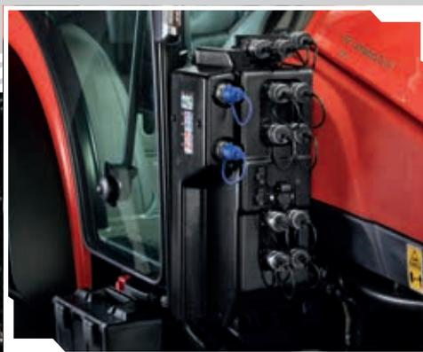
Fino a 4 distributori ventrali ad alta portata e fino a 3 distributori idraulici duplicati da quelli posteriori e 2 a scarico libero.
