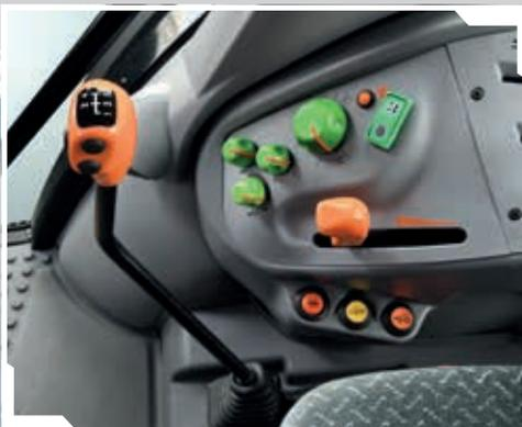
Sollevatore posteriore elettronico con ammortizzamento delle vibrazioni.
