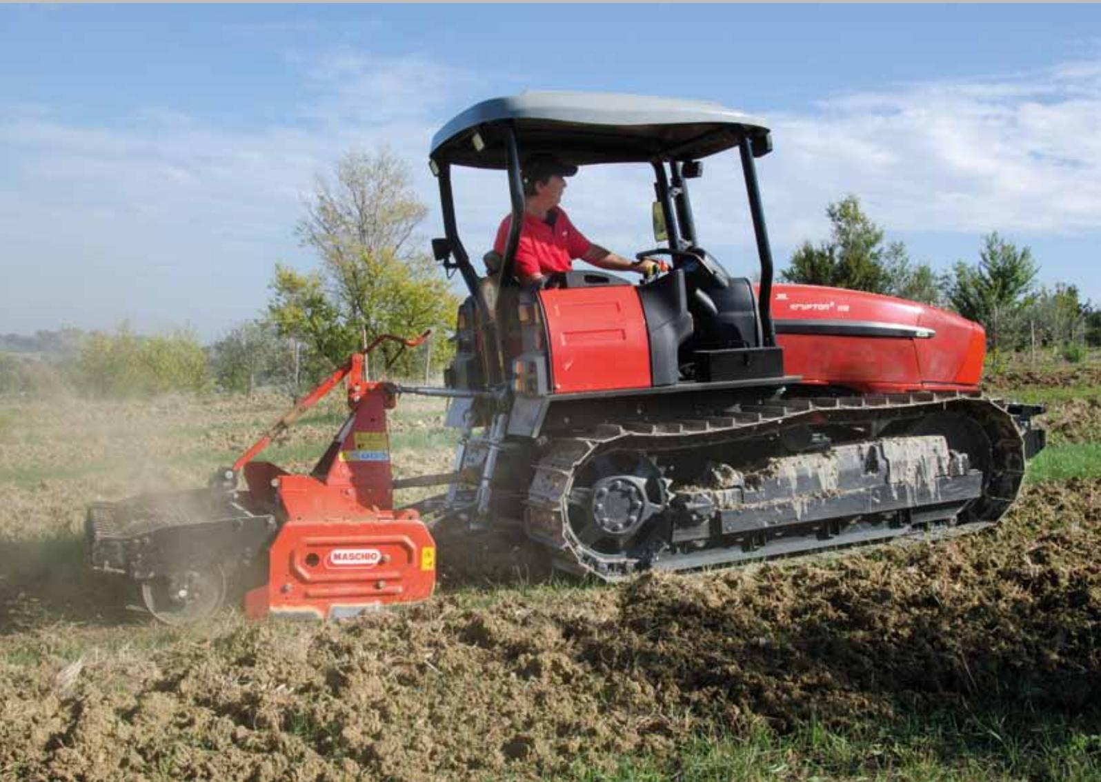
Il sollevatore posteriore è di tipo meccanico con controllo dello sforzo, posizione, misto e flottante ed ha una capacità di sollevamento di 3000 kg per tutte le versioni ed è in grado di soddisfare ampiamente le esigenze della categoria. Per Krypton<sup>3</sup> V, è disponibile anche in versione "Heavy duty" per attrezzature pesanti e che richiedono elevati sforzi di trazione.
