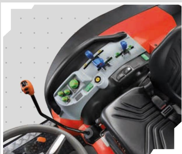
Il sollevatore elettronico consente un controllo dello sforzo e della posizione preciso ed efficace in qualsiasi condizione operativa. In più, oltre a permettere la regolazione della velocità di discesa, offre in standard la funzione di smorzamento delle vibrazioni durante i trasferimenti su strada con le attrezzature portate.
