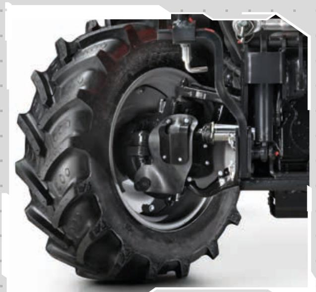
diferente de eixo. Com vista a assegurar que a máquina mantém uma configuração ideal em todas as situações, o sistema controla continuamente a capacidade de amortecimento. O software de controlo também inclui duas funções suplementares para melhorar a segurança ativa da máquina: Anti-Dive (anti-afundamento) e Anti-Roll (anti-rolagem).
