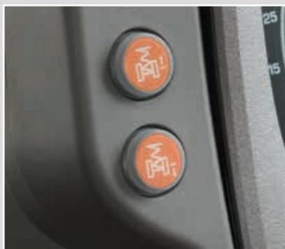
Novo: dois botões dedicados para ajuste manual da posição da suspensão dianteira para facilitar as operações de manutenção e garantir manobras de engate simples do equipamento dianteiro.
