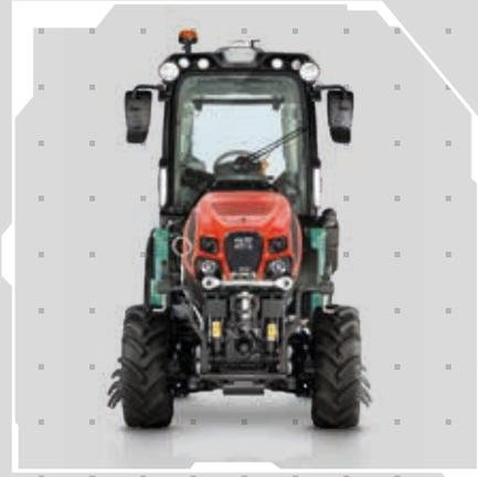
O elevado número de ligações hidráulicas (até 21) permite a instalação de combinações de alfaias (montadas à frente, no meio e atrás). O trator Frutteto CVT S pode ser equipado com um depósito de combustível moldado, que permite a instalação de alfaias de montagem central, mantendo a largura total do trator inferior a 1,3 m.
