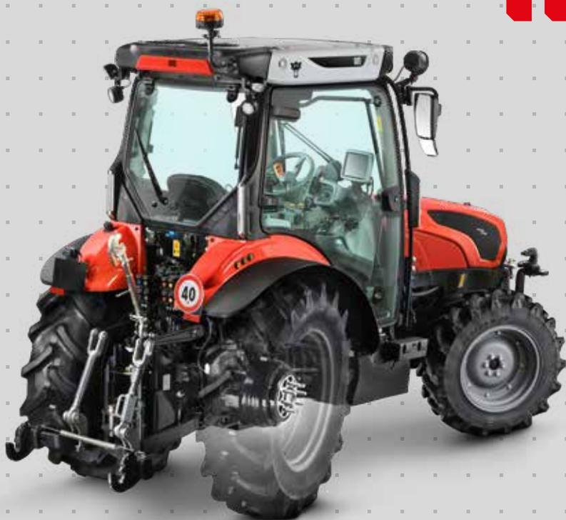
oposta ao eixo dianteiro, sincronizado com o movimento das rodas dianteiras. Esta estratégia de direção oferece ao utilizador a possibilidade de escolher entre duas modalidades diferentes que determinam o comportamento do eixo traseiro em relação ao eixo dianteiro. Ambas as modalidades reduzem significativamente o tempo e o espaço necessários para manobrar, tornando-as particularmente eficazes quando se trabalha em espaços confinados e se efetuam viragens de fim de fila.
