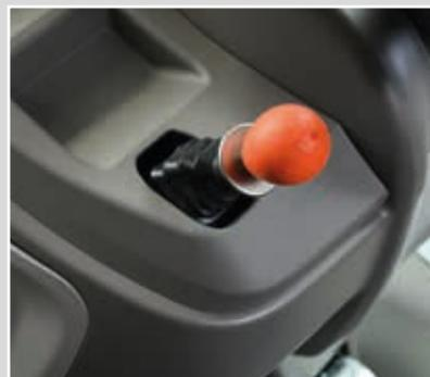
Todos os tratores SAME Frutteto CVT estão equipados com travagem nas quatro rodas e travão de estacionamento hidráulico (HPB).
