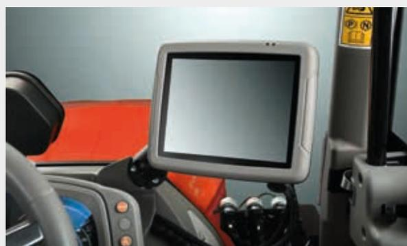
O Frutteto CVT, Frutteto CVT S e Frutteto CVT V também pode ser equipado com o iMonitor 8", instalado no canto direito do painel com suporte ajustável.
