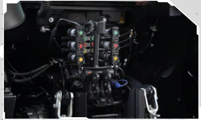
kann mit einer Hydraulikanlage mit einem Durchfluss von 55 l/min ausgestattet werden. Zur Ergänzung des hydraulischen Angebots sind 2 oder 3 Hecksteuerventile mit mechanischer Steuerung, Durchflussreglern, Hydraulikölsammlern und drucklosem Rücklauf erhältlich. Der neue Explorer
