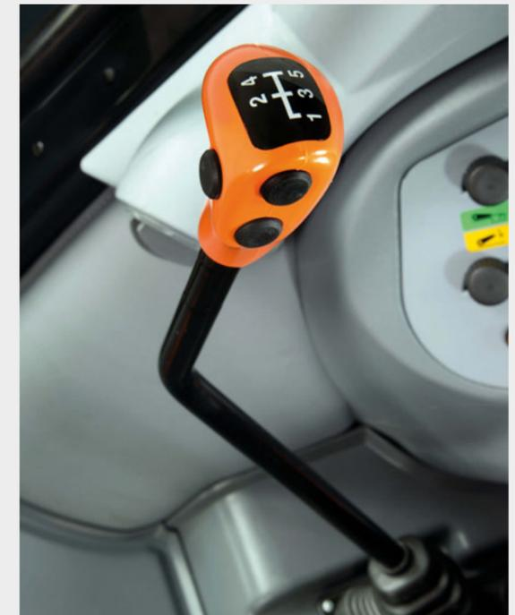
Das "Overspeed" Getriebe gestattet durchschnittlich im 5. Gang mit der "schnellen" Gruppe bei 40 km/h eine Motordrehzahl von 400 U/Min unter dem maximalen Leistungsbereich, mit einer Kraftstoffersparnis von ca. 11/12%.
