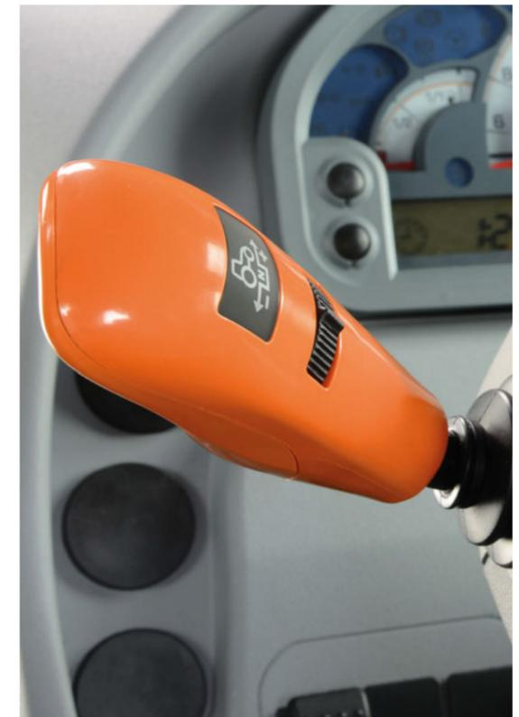
Abschnitt hydraulisches Wendegetriebe mit STOP&GO-System
