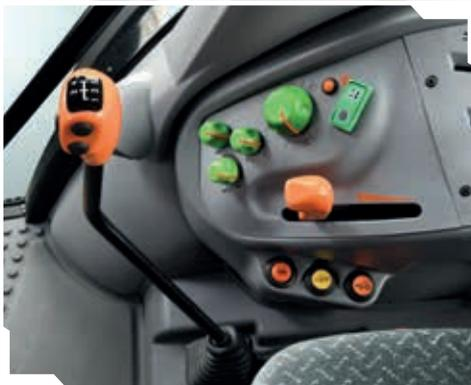
Elektronischer Heckkraftheber mit Schwingungsdämpfungsfunktion.
