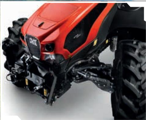
ActiveDrive – gefederte Vorderachse mit Einzelradaufhängung.
