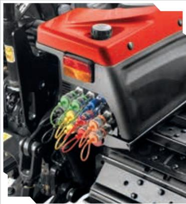
Hydraulische Zusatzsteuerventile hinten mit bis zu 10 Anschlüssen.
