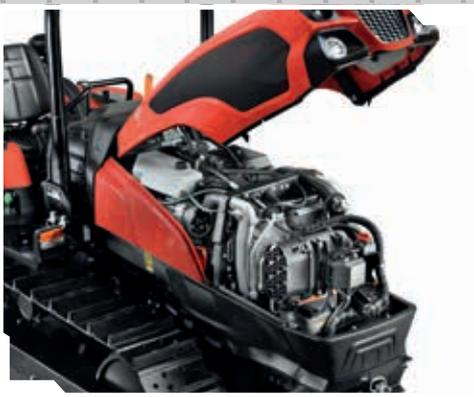
FARMotion-Motor, 3-Zylinder, Abgasstufe III B.
