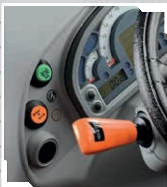
Hydraulisches Wendegetriebe mit Stop&Go-Funktion.
