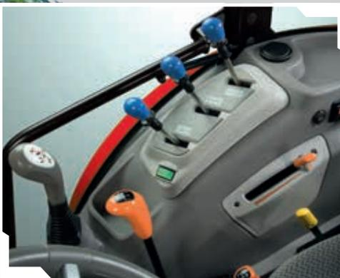
Ergonomische rechte Konsole mit neuer EasyLift-Steuerung.
