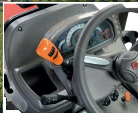
PowerShuttle mit SenseClutch.
