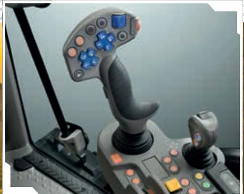
Die vollständig in den Sitz integrierte MaxCom-Armlehne ist die Schaltzentrale der Frutteto CVT S- und V-Traktoren.
