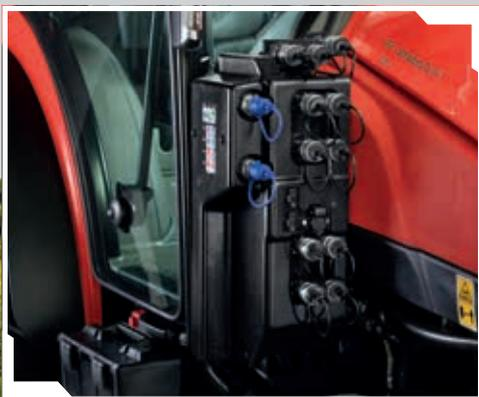
Bis zu 4 High-Flow-Zwischenachs-Zusatzsteuerventile und bis zu 3 hinten doppelt vorhandene hydraulische Anschlüsse, sowie 2 drucklose Rückläufe.
