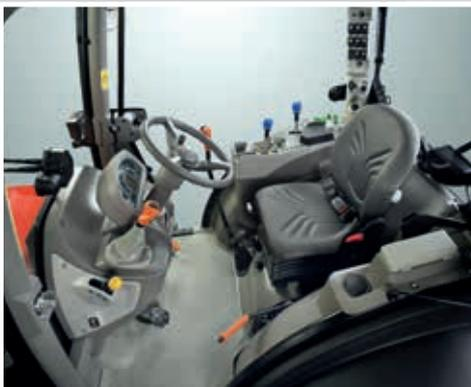
Neue komfortable Kabine mit ebenem Boden und neuer Konsole.
