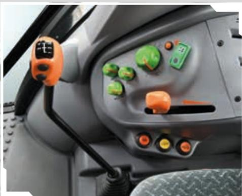
Elektronischer Heckkraftheber mit Schwingungsdämpfungsfunktion.
