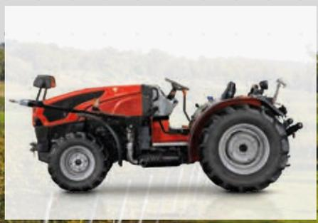
Erhältlich mit Kabine oder mit klappbarem 2-Pfosten ROPS.
