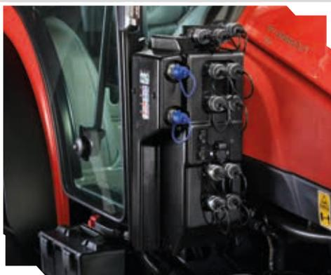
Bis zu 4 High-Flow-Zwischenachs-Zusatzsteuerventile und bis zu 3 doppelt vorhandene hydraulische Anschlüsse hinten, sowie 2 drucklose Rückläufe.
