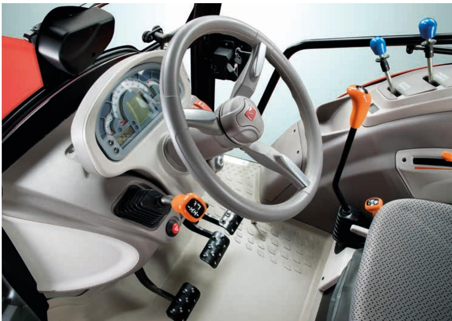
min dedicada al elevador y a los distribuidores auxiliares de 4 vías (6 opcionales), dotados del clásico control mecánico. Para garantizar la máxima seguridad y fluidez en la conducción incluso con el motor al ralentí, el circuito de dirección cuenta con una bomba independiente adicional de 18 l/min. El elevador trasero tiene una capacidad máxima medida cerca de las rótulas de 2500 kg, que, con los cilindros adicionales opcionales,
