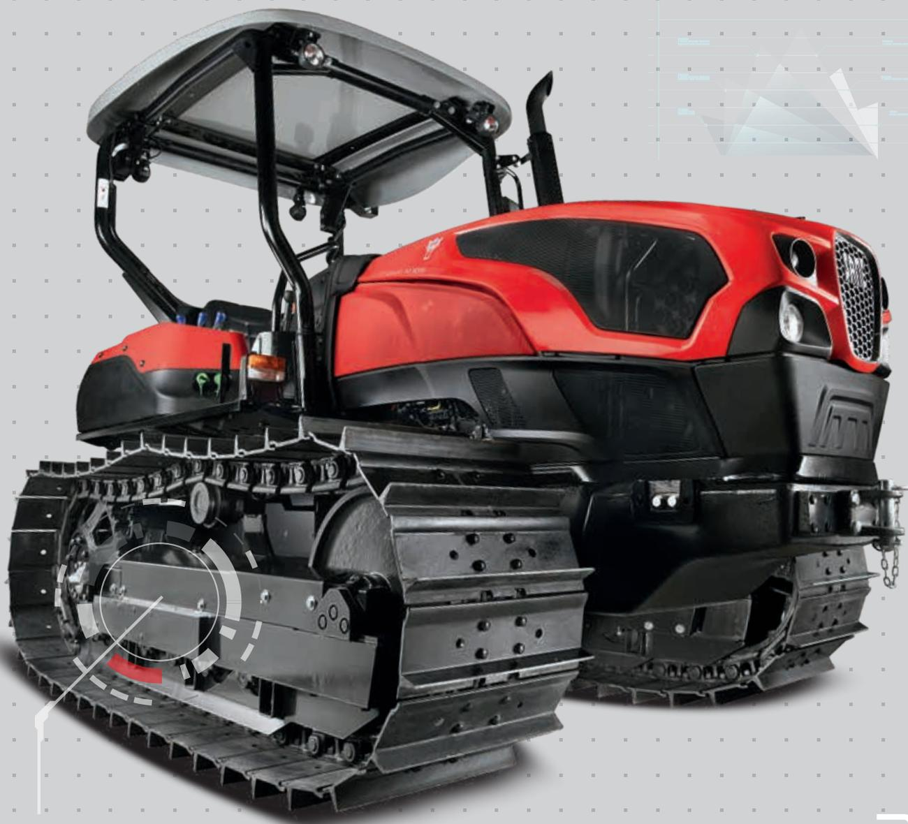
Orugas con numerosas opciones: desde la clásica de acero (en seco, semilubricada o lubricada) hasta la de goma con alma de acero "ComfortTrack".
