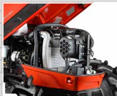
Motores FARMotion, 3 cilindros, Fase III B.
