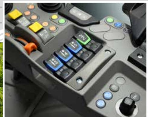
Distribuidores hidráulicos con control electrónico.
