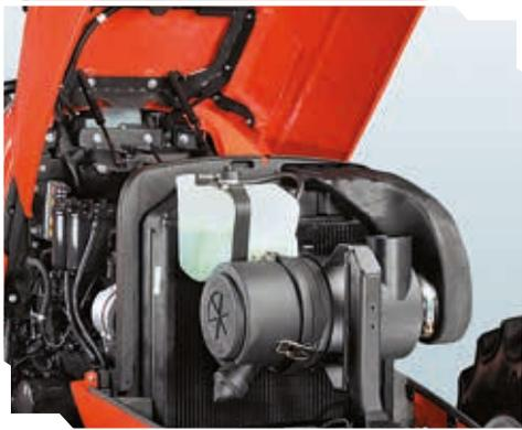
Capó completamente inclinable de una sola pieza.
