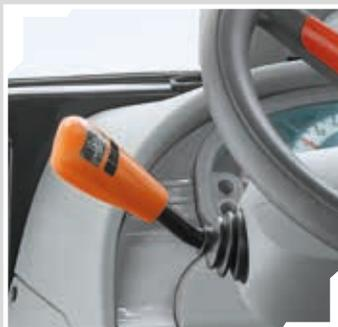
Modulación hidráulica para la sensibilidad del PowerShuttle.
