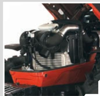
El capó de chapa metálica de una sola pieza facilita el acceso al motor.
