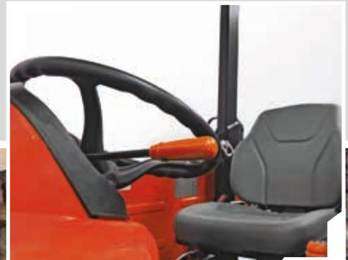
Palanca del inversor situada en una posición muy cómoda; bajo el volante.
