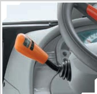
Modulación hidráulica para la sensibilidad del PowerShuttle.
