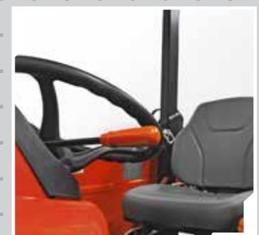
Palanca del inversor situada en una posición muy cómoda; bajo el volante.
