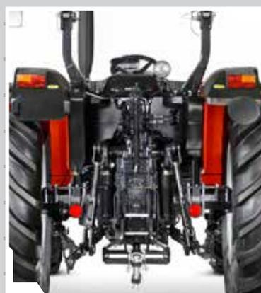
Capacidad de elevación trasera de hasta 4200 kg.
