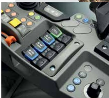
Distributeurs hydrauliques à commande électronique.
