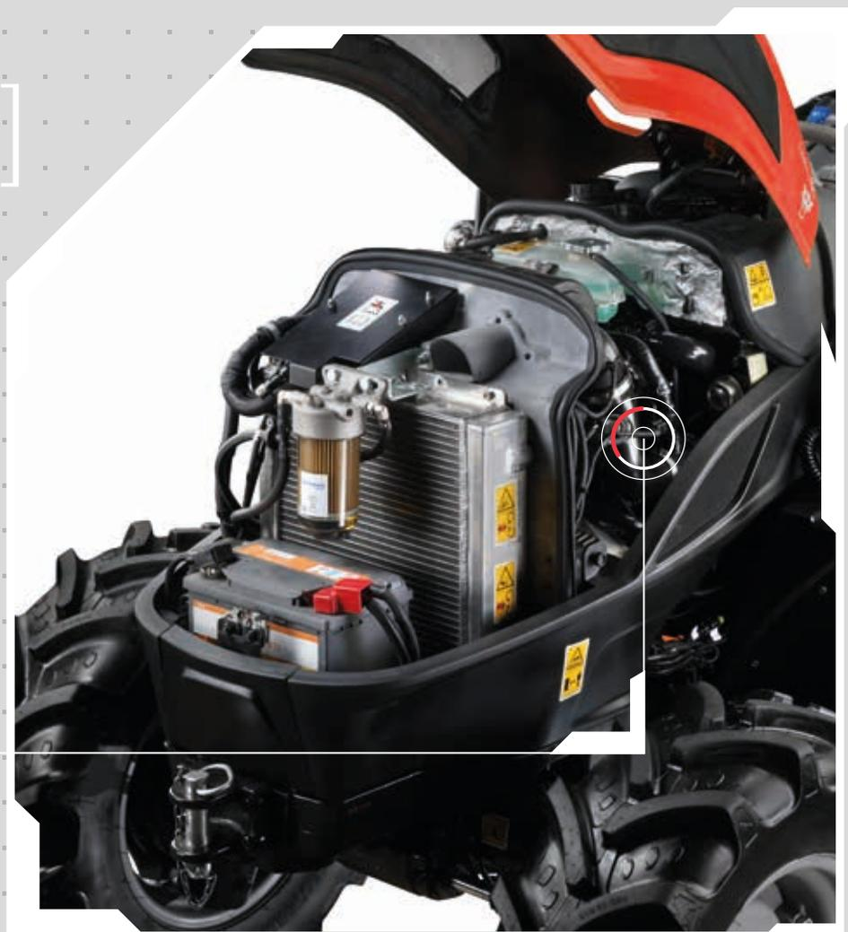
des gaz d'échappement (EGR) refroidi à l'extérieur, à commande électronique, d'un convertisseur catalytique DOC et d'un filtre à particules passif FAP.
