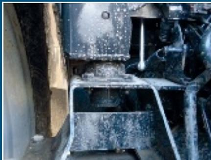
La cabine du Same Explorer profite d'une suspension par Hydro Silentbloc.
