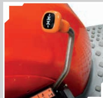
Inverseur synchro mécanique.
