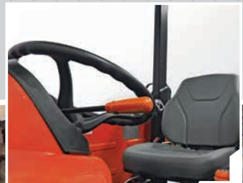
Levier d'inverseur commodément situé sous le volant.
