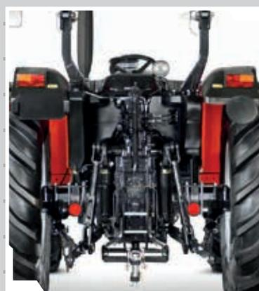
Capacité de relevage jusqu'à 4 200 Kg.
