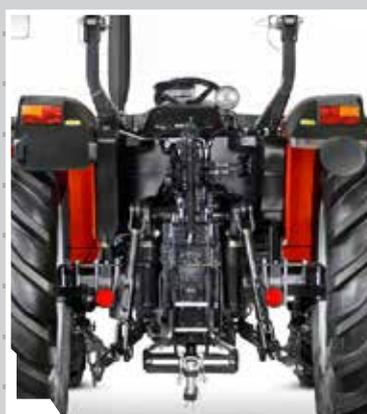
Capacité de relevage jusqu'à 4 200 kg.
