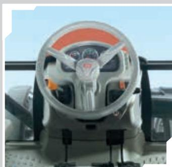
Cabine d'origine montée sur silentbloc.
