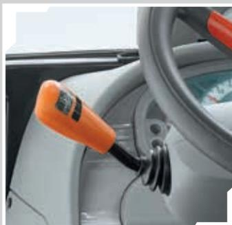
Modulation hydraulique pour sensibilité de l'inverseur.
