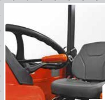
Levier d'inverseur commodément situé sous le volant.
