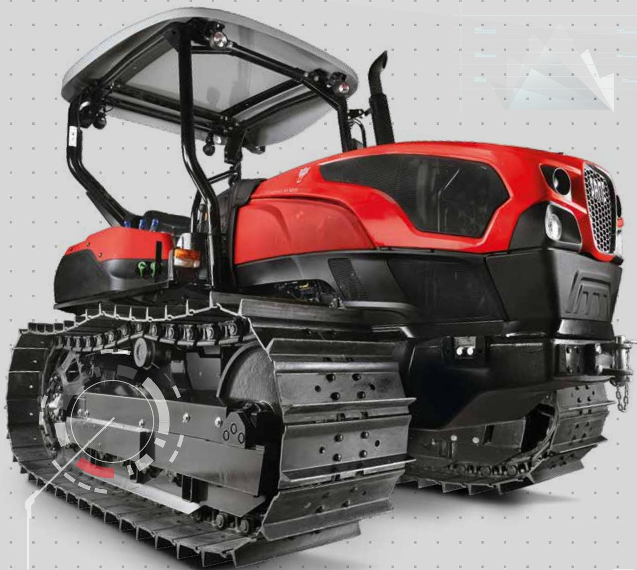
Ampie possibilità di cingolatura: da quella classica in acciaio (a secco, semilubrificata o lubrificata) a quella in gomma con anima in acciaio "ComfortTrack".
