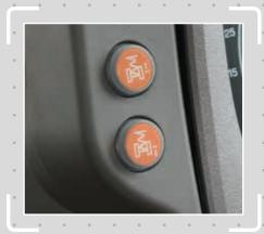
Nuevo: dos botones específicos para ajustar manualmente la posición de la suspensión delantera y facilitar las operaciones de mantenimiento y las maniobras de acoplamiento del implemento delantero.
