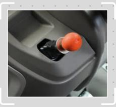
Todos los tractores SAME Frutteto EVT están equipados con frenos en las cuatro ruedas y un freno de estacionamiento hidráulico (HPB).
