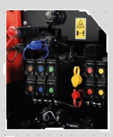
Hasta 5 distribuidores traseros de alto caudal y I de retorno libre. Frenos de remolque hidráulicos y Power Beyond opcionales.
