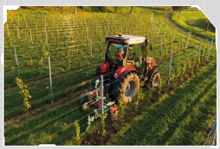
Todos los servicios hidráulicos, incluidos los elevadores y los distribuidores auxiliares, se alimentan mediante una bomba con caudal variable Load Sensing de alto rendimiento (con un caudal 100 l/min a un régimen de tan solo 1.750 rpm). Además, disponen de un circuito hidráulico independiente con una bomba de 42 l/min dedicada al sistema de la dirección hidráulica.
