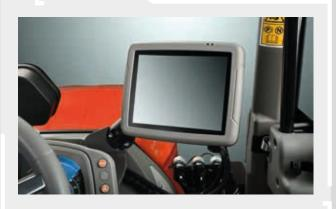
El Frutteto CVT, el Frutteto CVT S y el Frutteto CVT V también pueden equiparse con el iMonitor de 8", instalado en la parte derecha del salpicadero con un soporte regulable.
