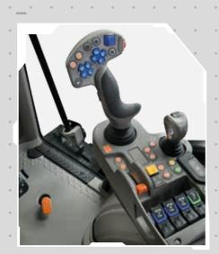
Los controles proporcionales facilitan el manejo de los distribuidores traseros y centrales, y se pueden asignar libremente a través de los ajustes de InfoCentre<sup>Pro</sup>.
