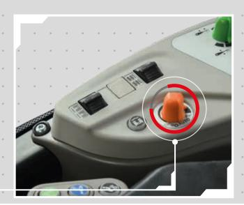
Gracias a un selector específico, podrás elegir entre varios modos de gestión del motor, que van desde el modo "ECO" para reducir al mínimo el consumo de combustible, hasta el "Power" para disponer de la máxima potencia.
