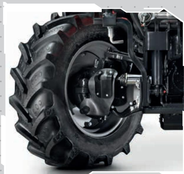
le système contrôle en permanence la capacité d'amortissement. Le logiciel de commande offre également deux fonctions supplémentaires afin d'améliorer la sécurité active de la machine : anti-plongée et anti-roulis.
