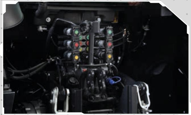
idraulico da 55 l/min. Per integrare l'offerta idraulica, sono disponibili 2 o 3 distributori ausiliari posteriori con comandi meccanici, regolatori di flusso, collettori di olio idraulico e scarico libero. Il nuovo Explorer Natural è dotato di serie di un sollevatore posteriore a comando meccanico. La capacità massima di
