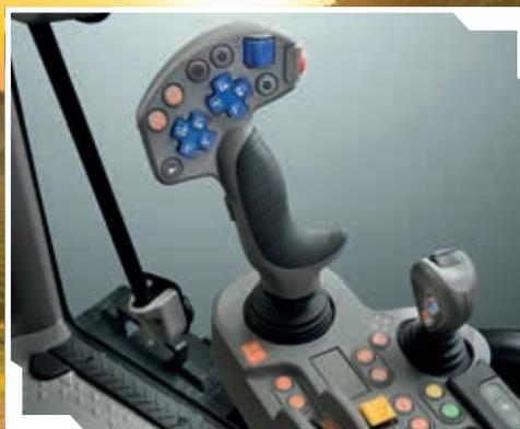
Totalmente integrado no assento, o apoio de braço MaxCom é o centro de controlo dos tratores Frutteto CVT S e V
