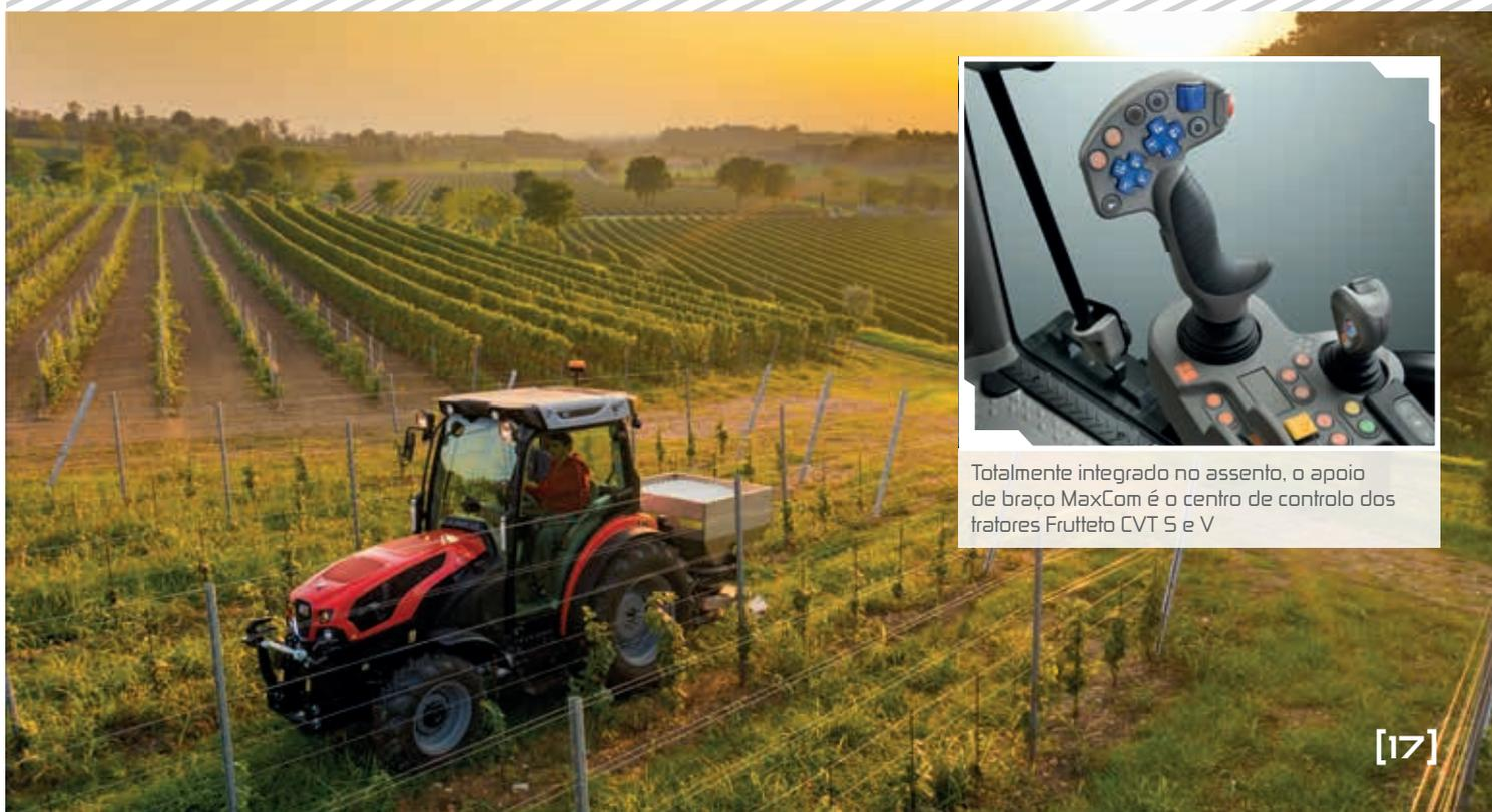
Totalmente integrado no assento, o apoio de braço MaxCom é o centro de controlo dos tratores Frutteto CVT S e V
