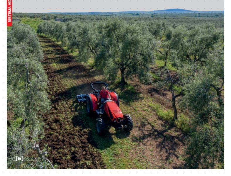
normalmente só podem ser utilizadas em tratores maiores. O engate de três pontos pode ser configurado com extremidades de engate inferior convencionais ou com acopladores de engate rápido. Um elevador frontal de 2100 Kg também está disponível como opção para uma capacidade ainda
