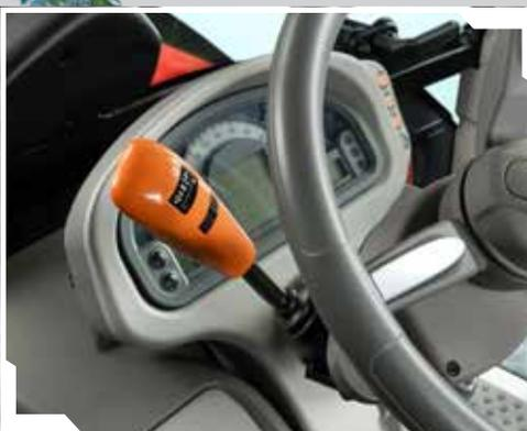
PowerShuttle com funções SenseClutch, Stop&Go e ComfortClutch disponíveis.
