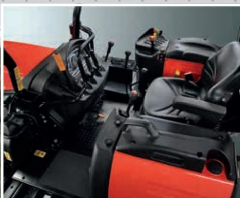
Posição de condução com piso plano e nova disposição das alavancas de direção.
