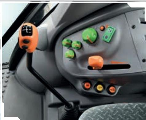
Elevador traseiro eletrônico com a função amortecimento das vibrações.
