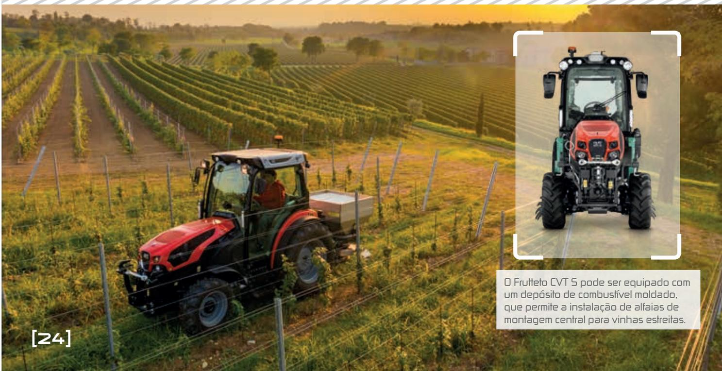
O Frutteto CVT S pode ser equipado com um depósito de combustível moldado, que permite a instalação de alfaias de montagem central para vinhas estreitas.
