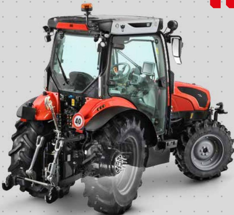
zur Vorderachse gelenkt, mit der Bewegung der Vorderräder synchronisiert. Bei dieser Lenkstrategie kann der Benutzer zwischen zwei verschiedenen Modi wählen, die das Verhalten der Hinterachse im Verhältnis zur Vorderachse bestimmen. Beide Modi reduzieren den Zeit- und Platzbedarf für das Manövrieren erheblich und sind daher besonders effektiv bei Arbeiten auf engem Raum und beim Wenden am Reihenende.
