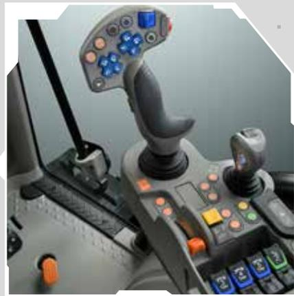
Einfach zu bedienende Heck- und Zwischenachs-Zusatzsteuerventile dank Proportionalsteuerung. Die Steuerungen können über InfoCentre<sup>Pro</sup> Einstellungen frei zugewiesen werden.
