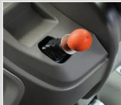
Alle SAME Frutteto CVT-Traktoren sind mit einer Allradbremse und einer hydraulischen Feststellbremse (HPB) ausgestattet.
