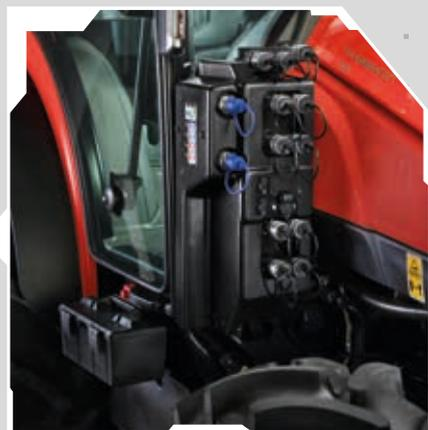
Bis zu 4 High-Flow-Zwischenachs Zusatzsteuerventil und bis zu 3 von hinten doppelt vorhandene hydraulische Anschlüsse, sowie 2 freie Rückläufe.
