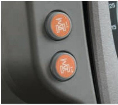
Neu: Zwei Tasten für die manuelle Einstellung der Vorderradaufhängung erleichtern die Wartungsarbeiten und ermöglichen ein einfaches Ankuppeln von Frontanbaugeräten.
