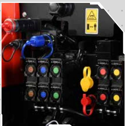
Bis zu 5 hintere High-Flow-Zusatzsteuerventile und 1 freiem Rücklauf. Power Beyond und hydraulische Anhängerbremsen als Option.
