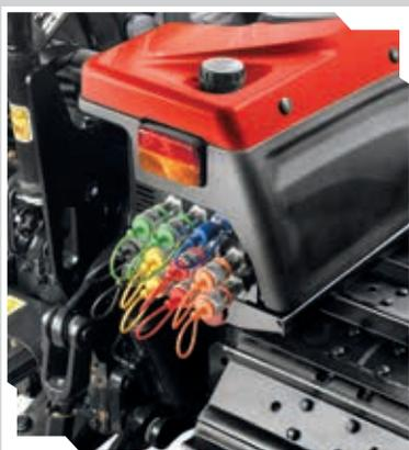
Distributeurs hydrauliques arrière jusqu'à 10 voies.
