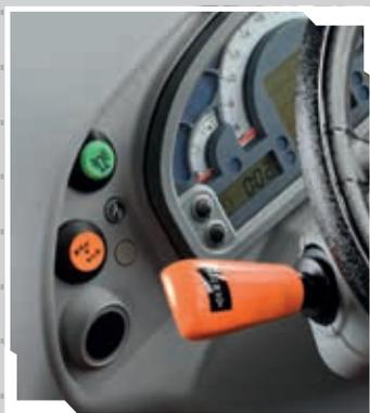
Inverseur hydraulique avec Stop&Go.
