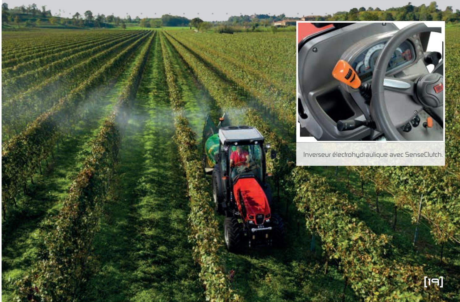
Inverseur électrohydraulique avec SenseClutch.
