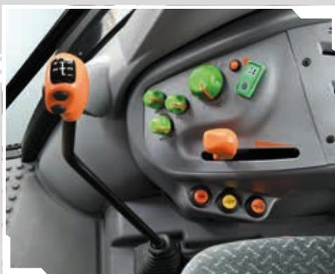
Relevage arrière électronique avec amortissement des vibrations.
