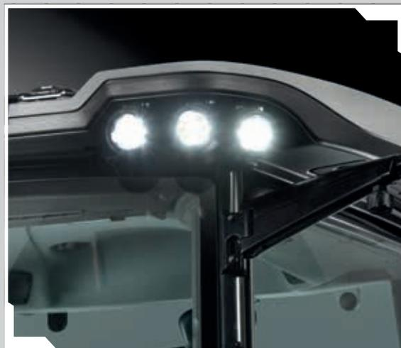
Techo de nuevo diseño con hasta 12 faros de trabajo LED.
