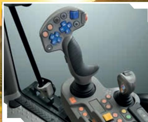
El reposabrazos MaxCom, completamente integrado en el asiento es el centro de control de los tractores Frutteto CVT S y V.
